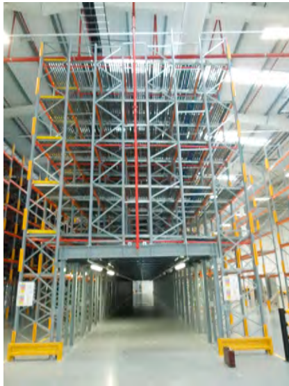
Installation dynamique pour palettes avec tunnel de retrait
