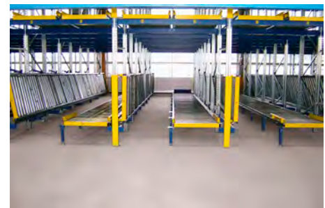
Rails à galets inclinables
