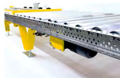
Système de séparation électrique ou pneumatique
